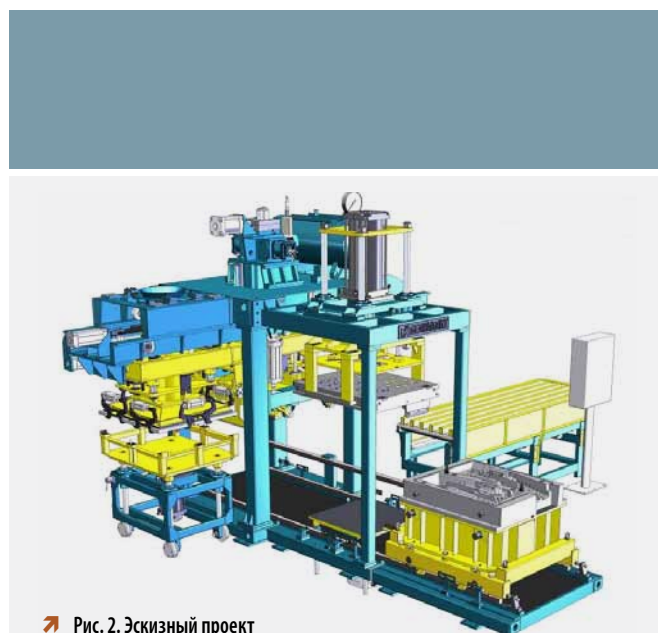
➔ Рис. 2. Эскизный проект стержневой машины модели 4785
