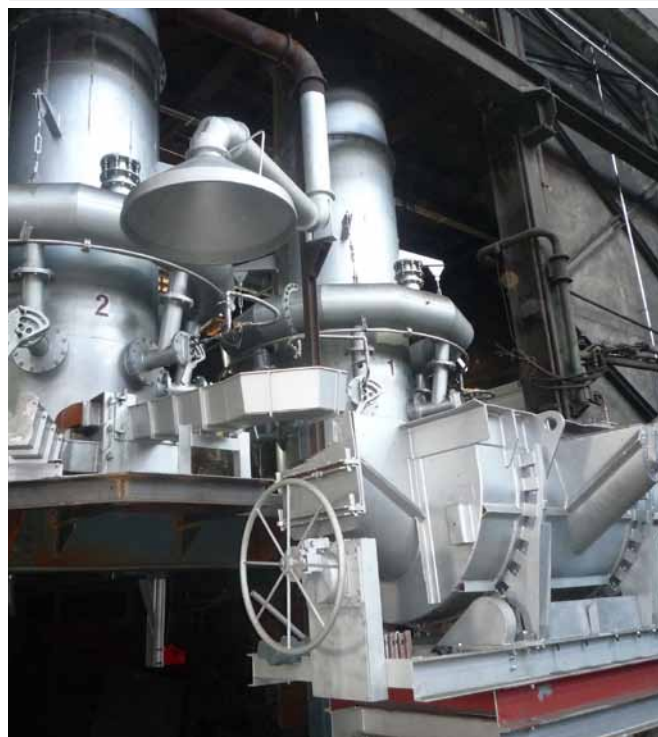
⬇ Рис. 4. Плавка в вагранках с холодным дутьем
