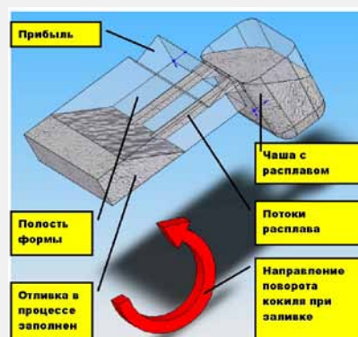
← Рис. 3. Схема метода самозаполнения формы на примере отливки «коллектор»
