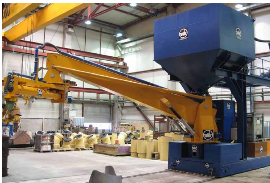
← Рис. 5. Комплексные станции Kuttner с выбивными решетками для нагрузок до 100 тонн
